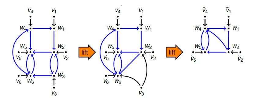
$$\begin{bmatrix} w_1 \\ w_2 \\ w_4 \\ w_5 \end{bmatrix} = \begin{bmatrix} 0 & 0 & G_{14}^0 & 0 \\ \frac{G_{21}^0}{1 - G_{23}^0 G_{32}^0} & 0 & 0 & 0 \\ 0 & G_{32}^0 G_{46}^0 G_{63}^0 & 0 & G_{46}^0 G_{65}^0 \\ 0 & \frac{G_{52}^0 + G_{56}^0 G_{63}^0 G_{32}^0}{1 - G_{56}^0 G_{65}^0} & \frac{G_{54}^0}{1 - G_{56}^0 G_{65}^0} & 0 \end{bmatrix} \begin{bmatrix} w_1 \\ w_2 \\ w_4 \\ w_5 \end{bmatrix} + \begin{bmatrix} \tilde{v}_1 \\ \tilde{v}_2 \\ \tilde{v}_4 \\ \tilde{v}_5 \end{bmatrix}$$
